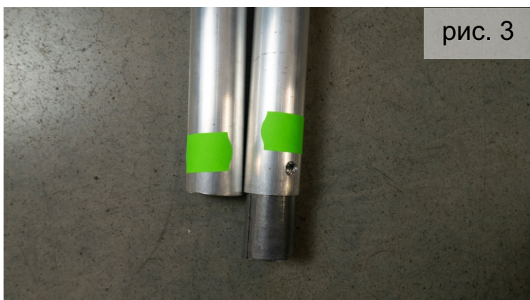
соединяемые части основных сборных стоек (помечены ярлыками зеленого цвета)
